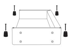
2 Posicionar el perno con la golilla en el orifico central de la pata plástica.
